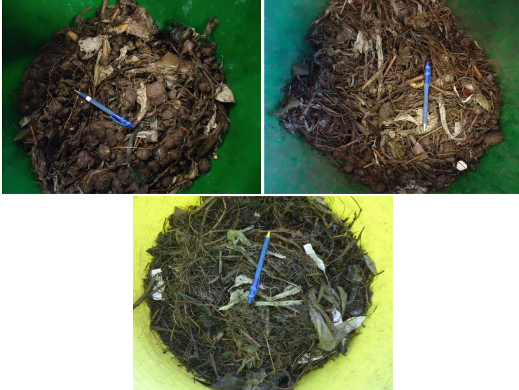
Figuur 8. Overflow homogenisatietrommel fractie 5-40 mm (links boven: voor bermgrasadditie; rechts boven: tijdens bermgrasadditie; onder: na bermgrasadditie)
