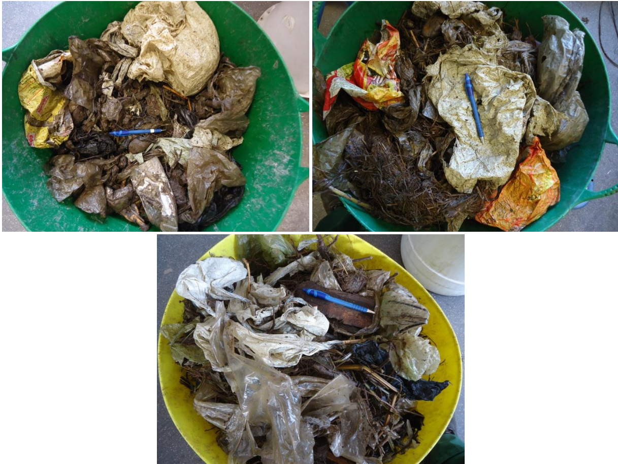
Figuur 7. Overflow homogenisatietrommel (links boven: voor bermgrasadditie; rechts boven: tijdens bermgrasadditie; onder: na bermgrasadditie)
